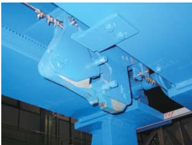
单点拉动滤板的移动钩
